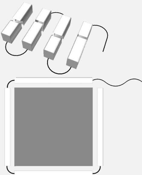
Fournitures de « chapelets » composés de 6 profilés CORNER LED de 610 mm de long pour éclairer ¼ d'une corniche en forme d'ellipse de 8 m de grand diamètre.
